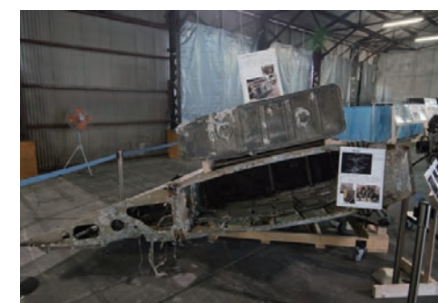
主翼と燃料タンク 翼の中がわかりやすいようにタンクを外してある
