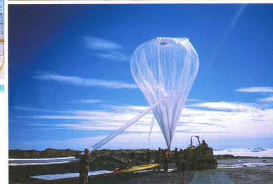
南極初の成層圏高度三十キロメートルまでの大気をサンプリングする回収気球実験の風景(一九九八年一月三日)
