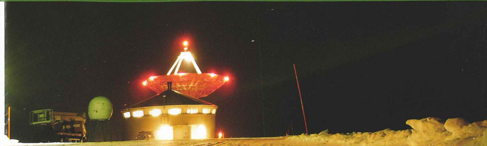
北極・ニーオルスン(79N,12E)で撮影したもの。緑色の縦線はライダーと呼ばれる観測装置のレーザー光線、横に伸びる緑色の帯はオーロラ、パラボラアンテナはVLBIという地理観測のためのもの。
