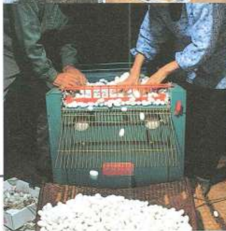
ケバトリを行い、繭を精製する。これを袋に詰め、目方を計って出荷する。
